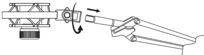
2. 麦克风印有“SM-18 PRO”产品型号和一个“O”心型指向性标记的一面是正面，将麦克风的正面对准声源，安置到防震架中，旋紧防震架底部的螺母到完全夹紧麦克风；
