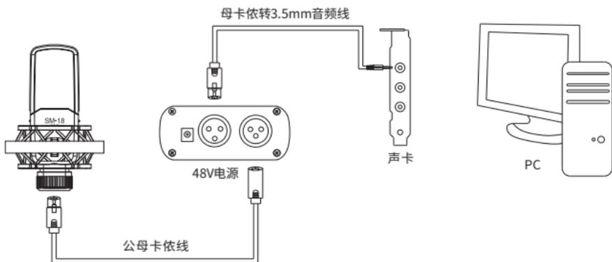
5. 将连接线固定在麦克风支架或吊杆上，在麦克风位置预留一圈连接线，这种做法可实现有效的隔震效果；
