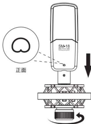
3. 通过防风网上的卡扣将防风网安装到防震架上；
