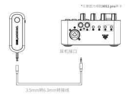
注: 为避免信号干扰,使用手机蓝牙功能连接声卡使用时,需增加接入3.5mm延长线再与声卡连接。
